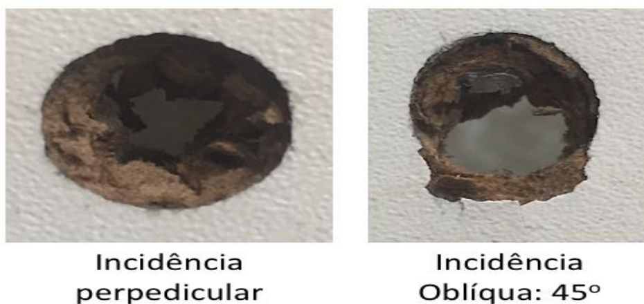
Figura 15 – Fotografia operada em ensaio prático realizado pelo autor. Mostra duas perfurações de tiro em lâmina de MDF em diferentes ângulos de incidência. Fonte: os conteudistas.
