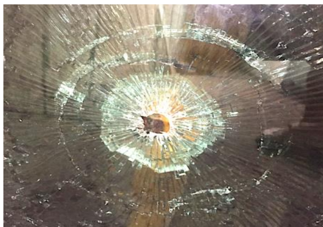
Figura 07 – Fotografia operada em ensaio prático realizado pelo autor. Mostra o primeiro tiro em um vidro temperado, sendo possível identificar as fraturas radiais e concêntricas.
