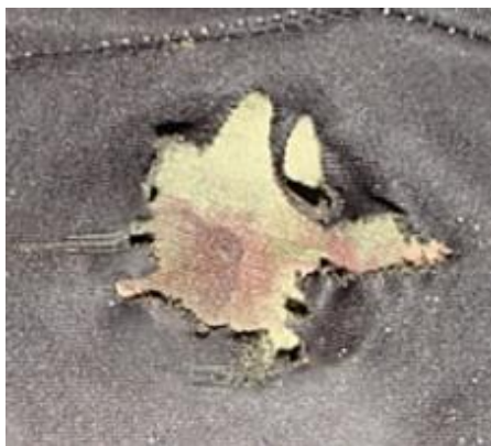
Figura 08 – Foto operada quando de exame de local – ICMG. Mostra a zona de chamuscamento constatada na camisa de poliéster usada pela vítima. Fonte: os conteudistas.
