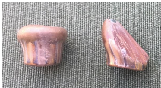
Figura 16 – Fotografia operada em ensaio prático que mostra dois projéteis deformados em virtude de impacto em estrutura de concreto.
