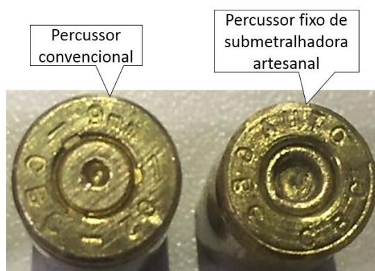
Figura 25 – Fotografia operada pelo autor durante exame pericial - ICMG. Mostra dois estojos percutidos sendo um deles por arma convencional e o outro por arma de fabricação artesanal dotada de percussor fixo no ferrolho. Fonte: os conteudistas.
