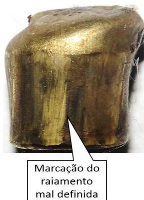
Figura 16 – Fotografia operada durante exame em projéteis – ICMG. Comparação entre projéteis propelidos por canos com raioamento convencional e poligonal, sendo possível perceber as diferenças nas marcações dos raioamentos.
