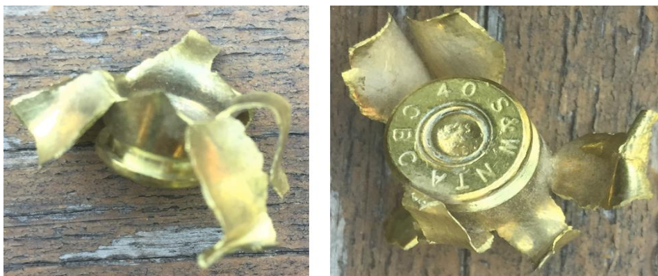
Figura 01 – Fotos operadas pelo autor que mostra o padrão de explosão do estojo, que teve sua espoleta detonada fora da câmara da arma ao cair no chão e atingir uma pedra.
