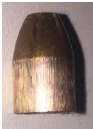
Figura 20 – Fotografia operada pelo autor em exame pericial realizado no laboratório de balística - ICMG. Mostra um projétil padrão colhido da submetralhadora mostrada na Figura 18. Fonte: Os conteadistas.
