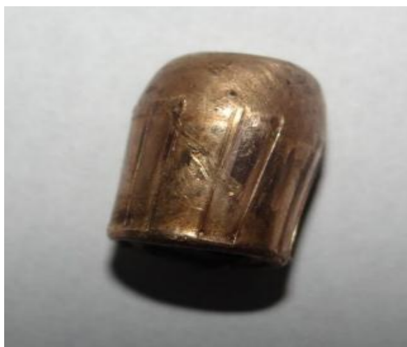
Figura 01 – Foto mostra um projétil apresentando deformações normais (setas) decorrentes da passagem pelo cano de arma de fogo de alma raiada. Fonte: os conteudistas.
