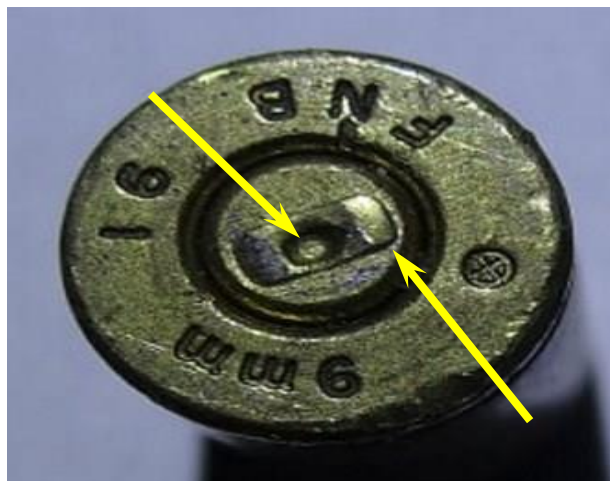
Figura 02 – Foto mostra deformações normais decorrentes do impacto do percussor (seta 1) e da marca da culatra (seta 2) da arma em estojo. Fonte: os conteudistas.
