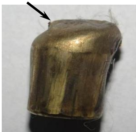
Figura 06 – Foto mostra as deformações acidentais (seta) produzidas em um projétil. Fonte: os conteudistas.
