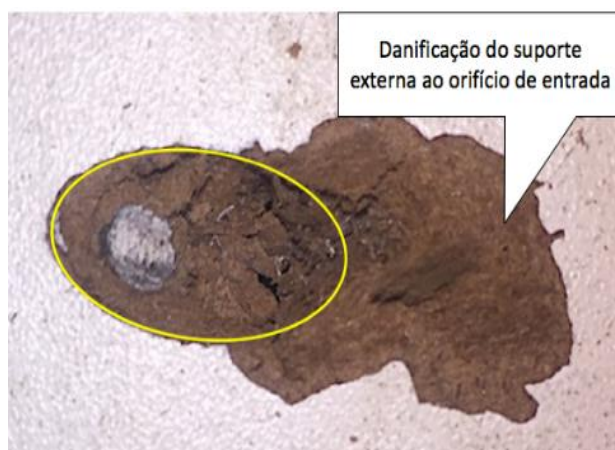
Figura 29 – Fotografia operada em ensaio prático que mostra um orifício de entrada de projétil com incidência oblíqua. Fonte: os conteudistas.
