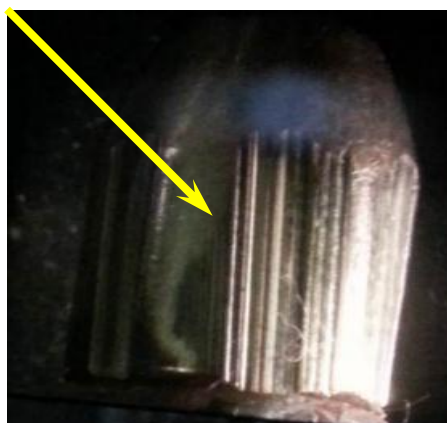
Figura 05 - Foto mostra as deformações periódicas produzidas em um projétil (seta) decorrente das rebarbas do compensador de recuo. Fonte: os conteudistas.
