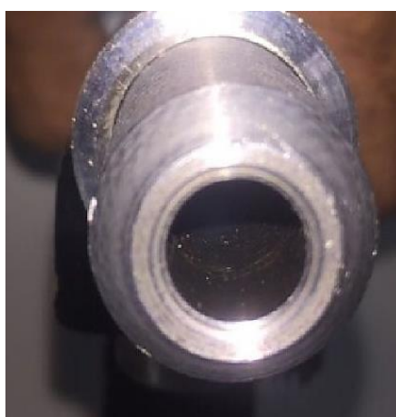
Figura 18 - Fotografia operada pelo autor em exame pericial realizado no laboratório de Balística - ICMG. Detalhe do interior do cano da submetralhadora mostrada na Figura 17. Nota-se a ausência de raioamento na alma do cano.
