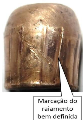
Figura 16 – Fotografia operada durante exame em projéteis – ICMG. Comparação entre projéteis propelidos por canos com raioamento convencional e poligonal, sendo possível perceber as diferenças nas marcações dos raioamentos.
