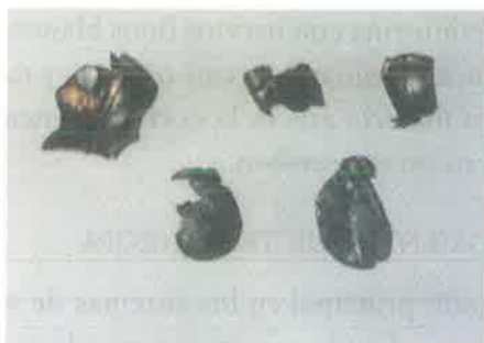
Figura 6.14b. Balas fragmentadas o descamisadas
