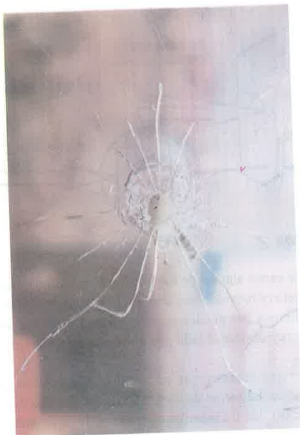
Figura 6.37. Orificio sobre un cristal de ventana, producido por una bala disparada con arma de fuego, cuyo cráter o bisel de astillamiento externo, indica una trayectoria de la bala de adentro a afuera, de abajo a arriba y ligeramente de izquierda a derecha, en relación con lo que observa
