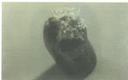
Figura 6.13. Restos de fibras y dibujo del tejido de la tela en la ojiva de la bala
