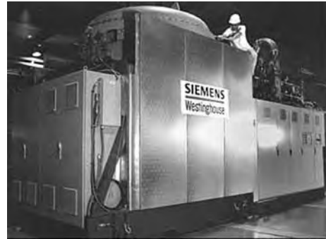
24.13 - L'installation SOFC, couplée à une turbine, de Irvine
